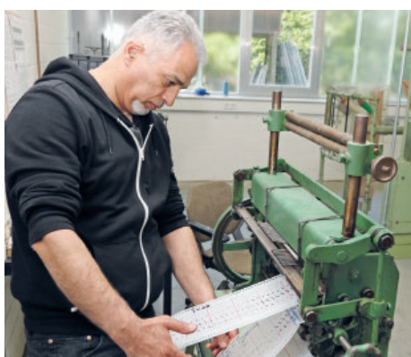
Klassische Technik: Weber Fadi Zaher Aldin fertigt Lochkarten für die Maschinen.
