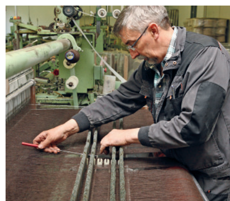
Routinier bei der Arbeit: Webmeister Helmut Neeland an einer Greiferwebmaschine.
